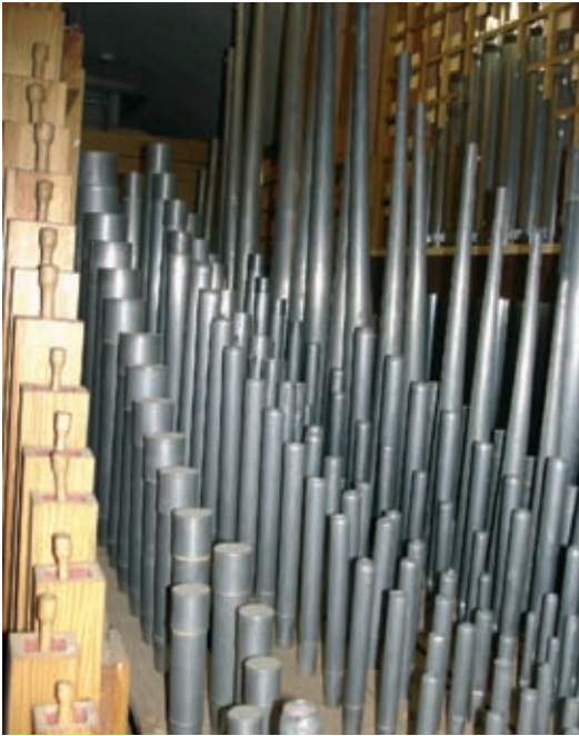
Blick in das Haupt- und Nebenwerk. Jede Pfeifenreihe gleicher Bauart entspricht einem Register.
